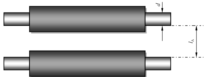
图 3 滚筒中心距试验
